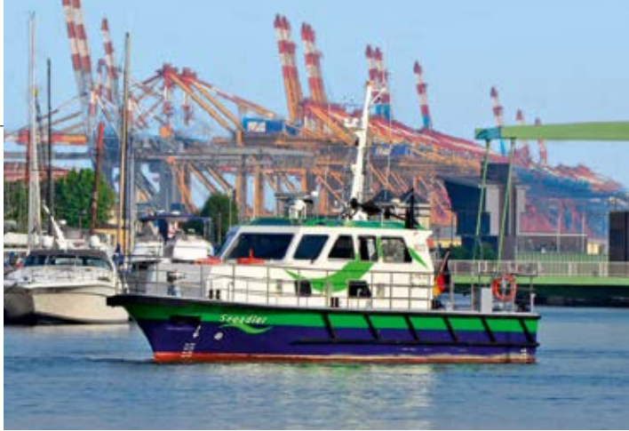
Die 2016 getaufte „Seeadler“ (l.) ist Teil der Marke „greenports“: Sie verfügt über einen Hybridantrieb, dessen abgasoptimierter Dieselmotor eine Kraftstoffersparnis von 25 Prozent ermöglicht und den Ausstoß von Stickoxid und Kohlendioxid deutlich reduziert. Die Flotte von bremenports umfasst derzeit acht E- und drei Hybridfahrzeuge.
