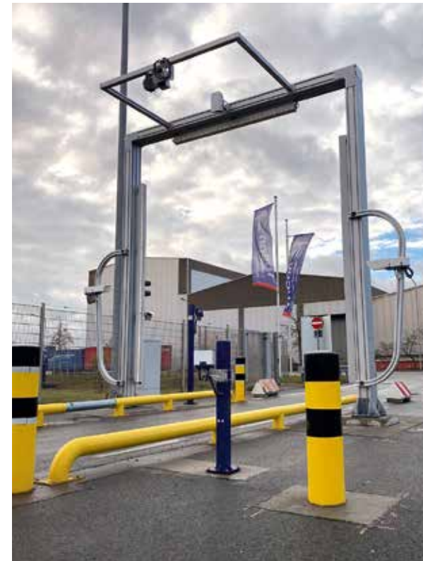
Am OCR-Gate von TriCon werden Momentaufnahmen des Zustands der Ladeeinheit erstellt.
