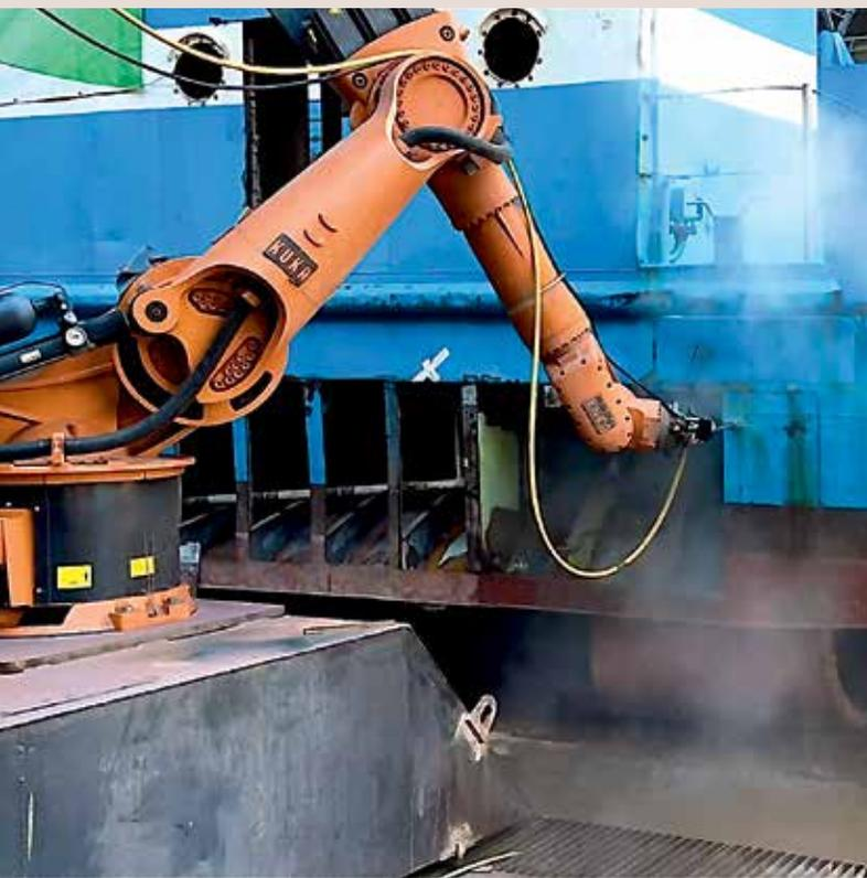
Roboter im Einsatz: Hier wird ein Schiffsteil mit Hochdruck und einem Wassersandstrahlgemisch zerschnitten.
