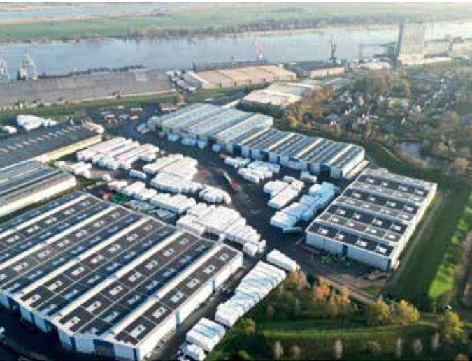
Unten vom Gelände aus sind nur die multifunktionalen Lagerhallen zu sehen. Erst der Blick von oben zeigt die 31.000 in verschiedene Himmelsrichtungen ausgerichteten Module, mit denen J. MÜLLER bereits 31 Prozent des benötigten Stroms selbst erzeugt.
