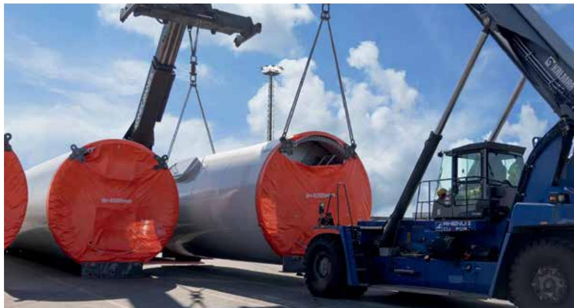
In Cuxhaven werden alle Großkomponenten für Offshore-Windkraftanlagen umgeschlagen, darunter auch die Turmsegmente.
